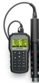
3 pav.. Nešiojamas, vandeniui atsparus, daugiafunkcis matavimo prietaisas HI98549 .
