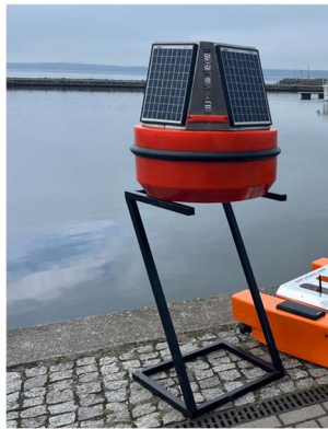
2 pav. Autonominis vandens kokybės stebėsenos plūduras
